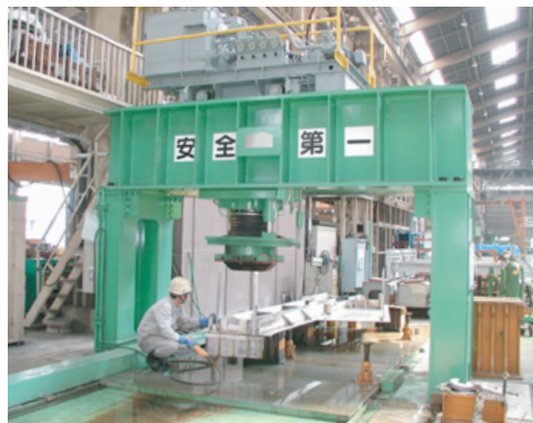
2MNプレス 積載可能質量 10t 電動機 15kW
