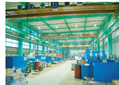
5tonクレーン1基、 3.8tonクレーン3基があり、 主に荷受け・機械加工・大型ブロック 製缶・塗装などを行います。
