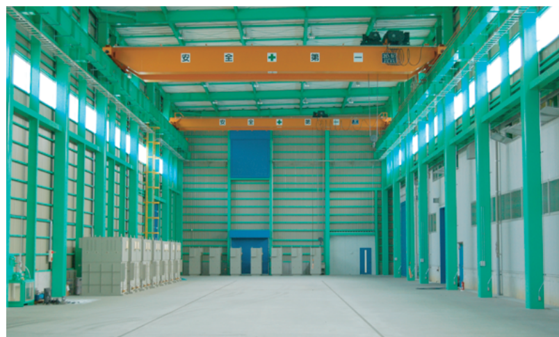
20ton/5tonクレーン1基、 フック下10m、 5tonクレーン1基があり、 主に大型製品の 組立などを行います。
