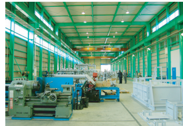
5tonクレーン3基があり、 主に検査・組立・溶接などを 行います。
