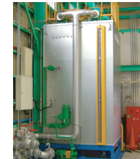
◎電気容量 300kVA ◎200V・400V級インバータ ◎耐圧テスト 70MPa ◎タンク 10,000ℓ ◎NAS 8級管理
