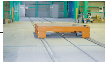
第1～第2～第3工場を結ぶ、連絡 移動台車を装備しています。
