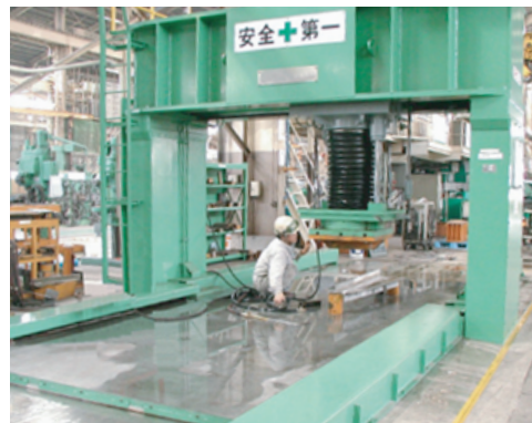
3MNプレス 積載可能質量 15t 電動機 22kW
