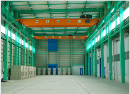
第3工場 1,300㎡ 20ton/5tonクレーン1基、フック下10m、5tonクレーン1基があり、主に大型製品の組立などを行います。
