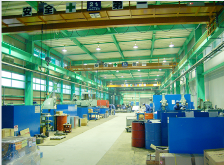
第2工場 1,400㎡ 5tonクレーン1基、3.8tonクレーン3基があり、主に荷受け・機械加工・大型ブロック・製缶・塗装などを行います。
